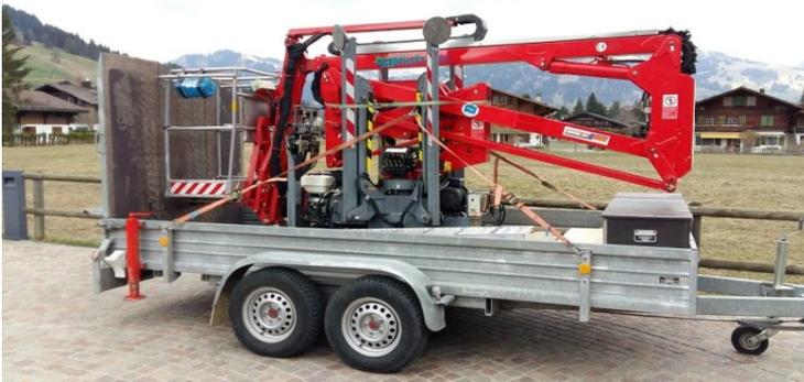
Die Arbeitsbühne kann flexibel im Innen und Aussenbereich eingesetzt werden. Dank der schlanken Bauart kann auch durch Zimmertüren gefahren werden
